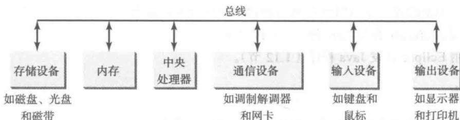
这些组件通过一个称为总线 (bus) 的子系统连接。你可以将总线想象成一个连接计算机组件的道路系统, 数据和电信号通过总线在计算机的各个部分之间传输。在个人计算机中, 总线搭建在主板上, 主板是一个连接计算机各个部分的电路板。
