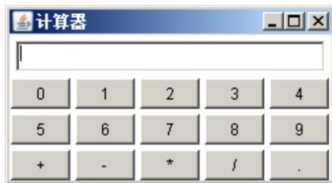
图11.11 使用GridLayout布局管理器的效果
