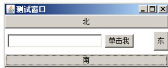
图11.10 向BorderLayout布局管理器中添加Panel容器
