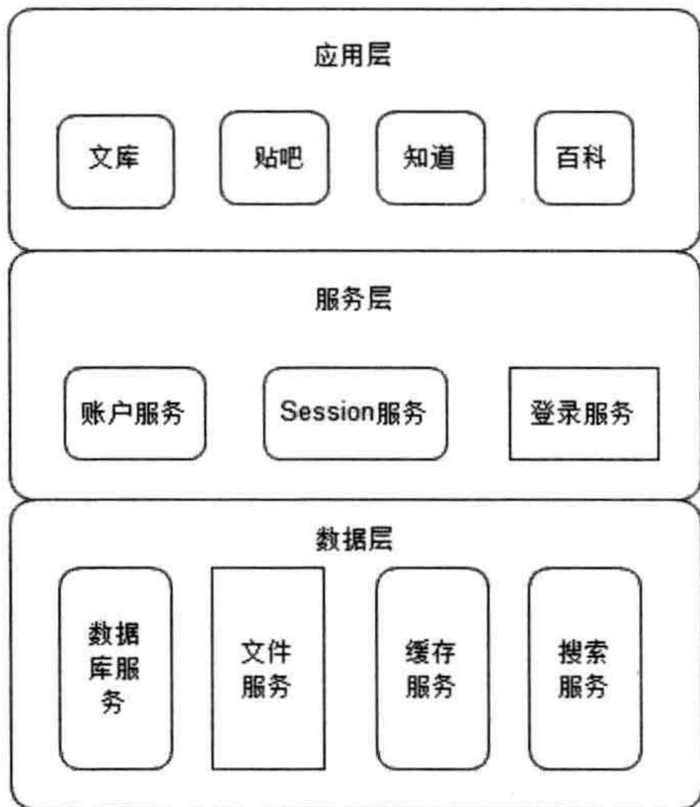
图 5.4 分层后按模块分割的网站架构模型
