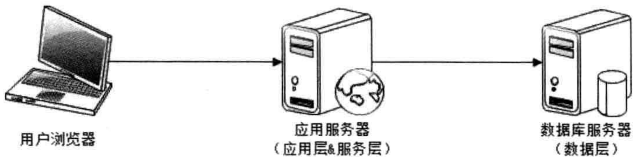
图 5.3 应用和数据分离部署的网站架构
