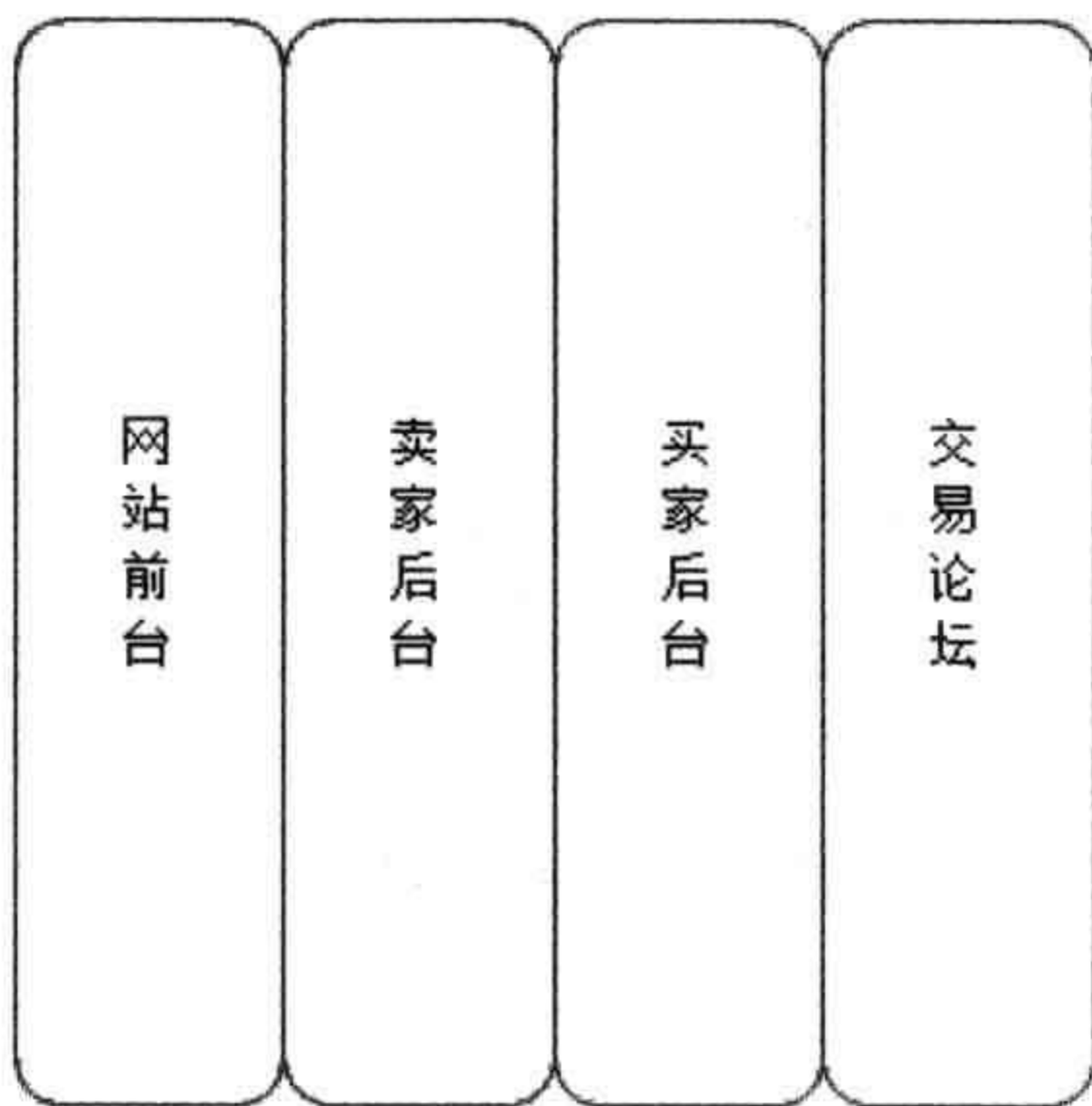
图 6.3 通过横向分离部署实现系统伸缩性
